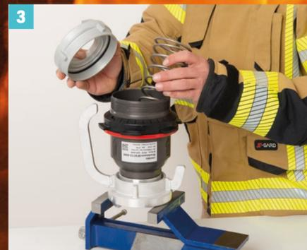
**3** Spannungsfreie Feder entfernen
