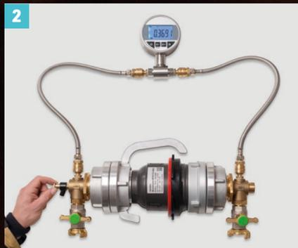
**2** Entleerungsventil schließen, Kugelhähne öffnen. System entlüften. Kugelhähne schließen und über Entleerungsventil Druck langsam ablassen.
