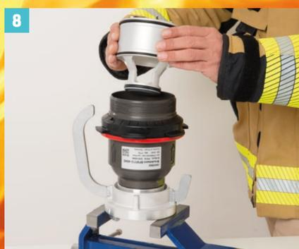
**8** Kolben und Feder wieder einsetzen
