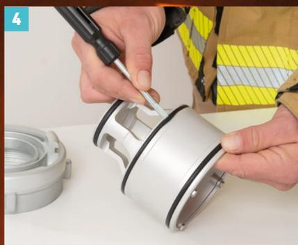
**4** O-Ringe prüfen und ggf. mittels Schraubendreher entfernen
