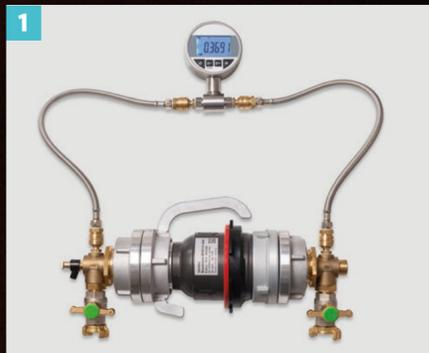
**1** TKA112 an den BFW112 anschließen, Entleerungsventil eingangsseitig. Schläuche zur Wasserversorgung und zum Abfluss (optional) anschließen.
