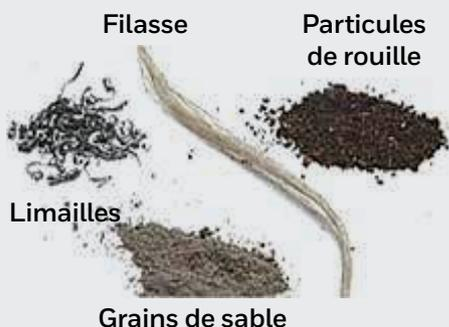
Ces éléments viennent très rapidement boucher les filtres de nos robinetteries ou pire encore, provoquer des dysfonctionnements au niveau des organes de sécurité (groupe de sécurité de chauffe-eau, disconnecteurs hydrauliques, vannes, électrovannes etc...)
