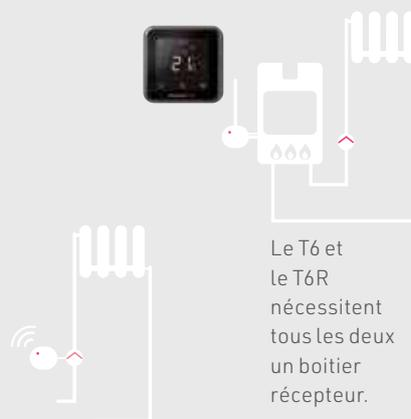
Le T6 et le T6R nécessitent tous les deux un boîtier récepteur.
